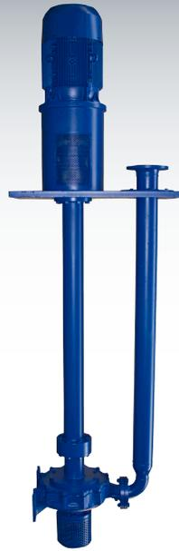
Bomba centrífuga en ejecución vertical, con rodete cerrado y columna lubricada por el propio líquido a impulsar. Sellado del eje con empaquetadura o cierre mecánico. Construcción en los materiales más adecuados al fluido a impulsar.
