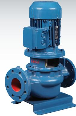
Electrobomba centrífuga monobloc vertical, con la aspiración e impulsión en línea. De un solo rodete o doble en un solo cuerpo. Sellado por cierre mecánico y motor normalizado. Para servicios de calefacción, aire acondicionado, refrigeración, abastecimientos y otras aplicaciones generales.
