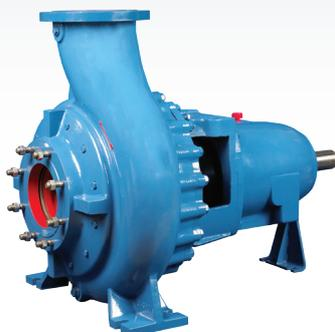
Bomba centrífuga en ejecución de proceso que corresponde en sus medidas principales con la norma DIN 24256. Con rodetes de canal, abiertos o vortex. Construcción en los materiales más adecuados al fluido a impulsar.
