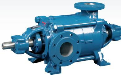
Bomba centrífuga multicelular de media presión, sellado con empaquetadura o cierre mecánico. Construcción en los materiales más adecuados al fluido a impulsar.
