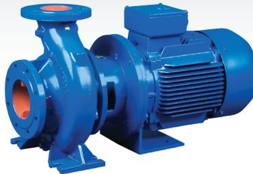
Electrobomba centrífuga en ejecución monobloc según DIN 24255 (EN 733), rodete cerrado, sellado con cierre mecánico y motor normalizado. Construcción en los materiales más adecuados al fluido a impulsar. Para servicios de calefacción, aire acondicionado, refrigeración, agricultura, abastecimientos, grupos contraincendios y otras aplicaciones generales.
