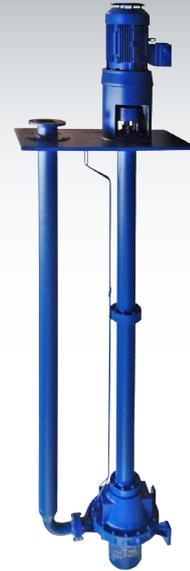
Bomba centrífuga vertical. Con columna lubricada por el propio líquido a impulsar, si este es limpio, o por agua exterior limpia. Sellado del eje por cierre mecánico o empaquetadura. Construcción en distintos materiales según el fluido a impulsar.
