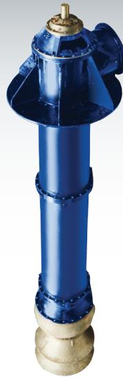
Bombas centrífugas verticales. Ejecución de pozo profundo con rodetes semi-axiales, abiertos o cerrados. Servicios de riegos, abastecimientos, refrigeración de centrales térmicas, desagües, etc.
