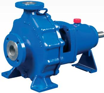
Bomba centrífuga en construcción de proceso según DIN 24256, ISO 2858, EN 22858 o bien ISO 5199. Sellado con empaquetadura o cierre mecánico. Construcción en los materiales más adecuados al fluido a impulsar. Servicios en procesos químicos y petroquímicos y otras aplicaciones.
