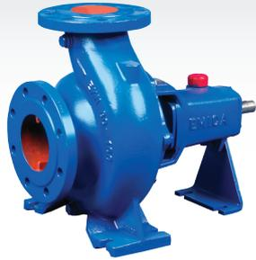
Bomba centrífuga según DIN 24255 (EN 733), rodete cerrado, sellado con cierre mecánico o empaquetadura. Construcción en los materiales más adecuados al fluido a impulsar. Para líquidos limpios sin componentes sólidos ni abrasivos. Para servicios de calefacción, aire acondicionado, refrigeración, agricultura, abastecimientos, circulación, agua de mar, grupos contraincendios y otras aplicaciones generales.
