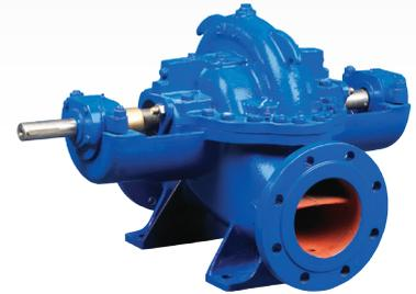
Bomba centrífuga de cámara partida, con rodete radial de doble flujo y empujes axiales equilibrados. Sellado con empaquetadura o cierre mecánico.
