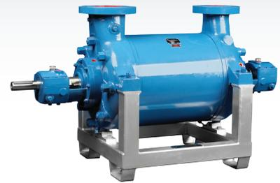
Bomba centrífuga multicelular de alta presión. Sellado con empaquetadura o cierre mecánico. Construcción en distintos materiales acorde con el fluido a impulsar.
